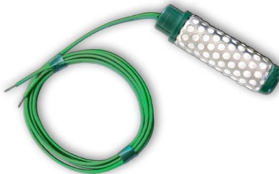
Ces sondes sont le plus souvent montées à l'extrémité de tubes en plastique pour qu'elles puissent être enterrées et que leurs câbles de connexion soient accessibles (ils passent dans le corps du tube et sortent par son autre extrémité). En voici une illustration :
