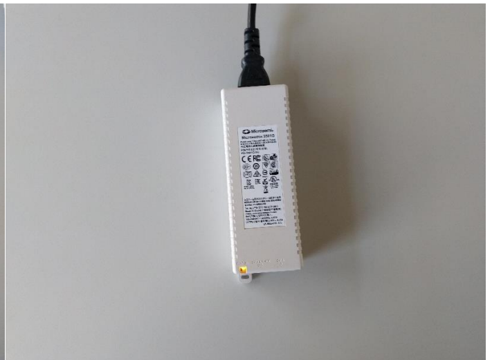
Injecteur PoE (sous tension)
