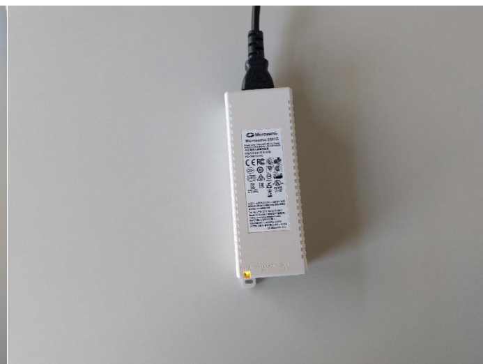
Injecteur PoE (sous tension)
