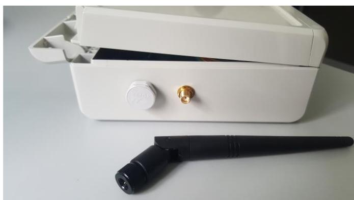
Figure 6: compensateur de pression (à gauche) et connecteur SMA LoRa (à droite) avec antenne LoRa (au 1<sup>er</sup> plan)
