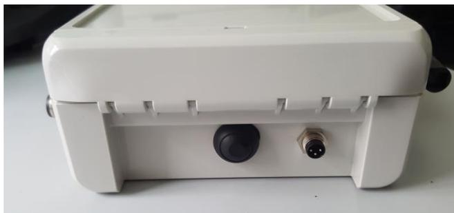
Figure 3: bouton de reset (gauche) et connecteur d'alimentation et de recharge externe (droite)
