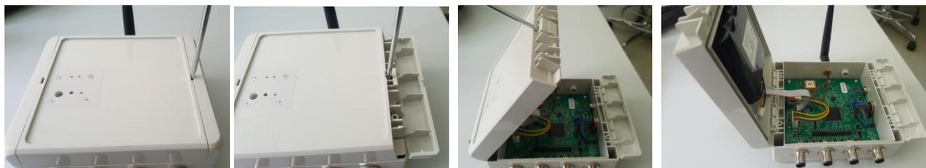
Figure 2: ouverture du boîtier
