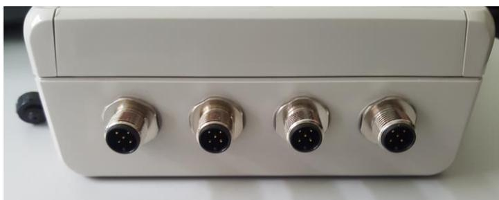
Figure 5: connecteurs M12 pour l'interfaçage capteur
