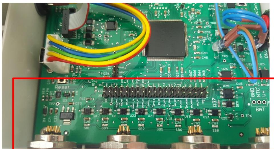
Figure 11: slot de connexion interne entre le microcontrôleur et les connecteurs M12
