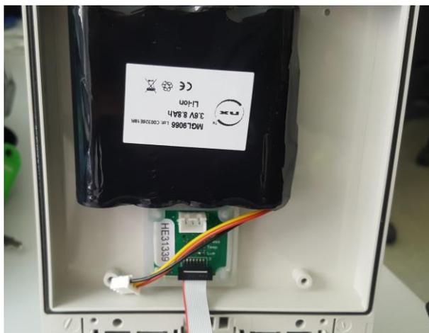
Figure 9: batterie sous le capot du boîtier
